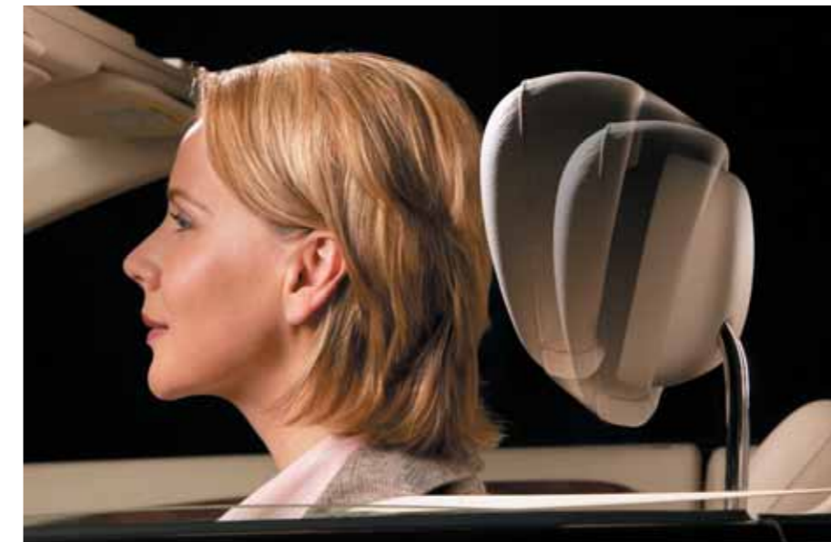
► El reposacabezas activo "Neck-Pro" de Mercedes se desliza hacia delante y hacia arriba
